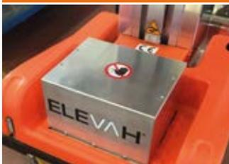
**4KIT:** kit de 4 batteries pour doubler l'autonomie de la machine
